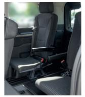
Optionale Dreh-Klappsitze in 3. Reihe ermöglichen eine flexible Nutzung des Fahrzeuges.
