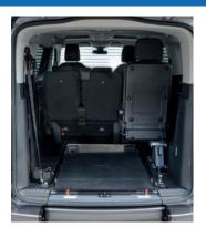
Mit der optionalen EasyFlex Rampe kann der Kofferraum voll genutzt werden.
