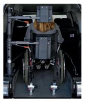
Das Fahrzeug kann mit der schwenkbaren Kopf- und Rückenstütze Future Safe ausgestattet werden.
