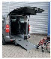
Bei ausgeklappter Rampe kann das Fahrzeug beguem mit dem Rollstuhl befahren werden.
