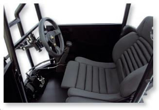
Ein **Handbediengerät für Gas & Bremse** simuliert durch Zug nach hinten das Gas geben und durch Druck nach vorne das Bremsen.
