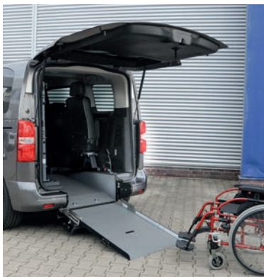
Bei ausgeklappter Rampe lässt sich das Fahrzeug bequem mit dem Rollstuhl befahren.
