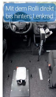
Heckeinstieg mit Bodenbegradigung für Selbstfahrer
