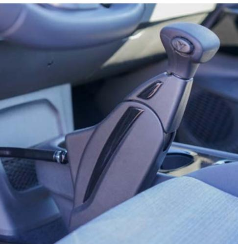
Das **Zug-Druck-Handgerät** zum Beschleunigen und Abbremsen des Fahrzeuges mit der Hand. Ziehen bedeutet Gas geben und nach vorne Drücken des Hebels verringert die Geschwindigkeit.
