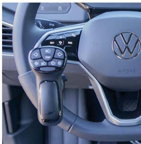
Der **Multifunktionslenkrad-drehknopf (MFD)** zum leichten und sicheren Lenken mit nur einer Hand. Gleichzeitig werden die wichtigsten Sekundärfunktionen, wie z.B. Blinken, Hupen, Betätigen der Scheibenwischer usw. über die Tasten reguliert.
