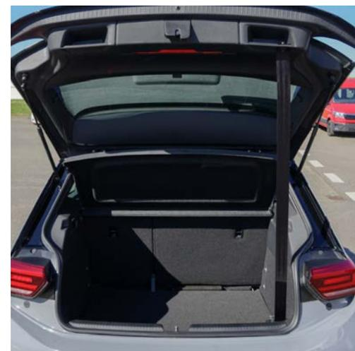
Die **Gurtrolle** ermöglicht das einfache Öffnen und Schließen des Kofferraumdeckels aus sitzender Position heraus.
