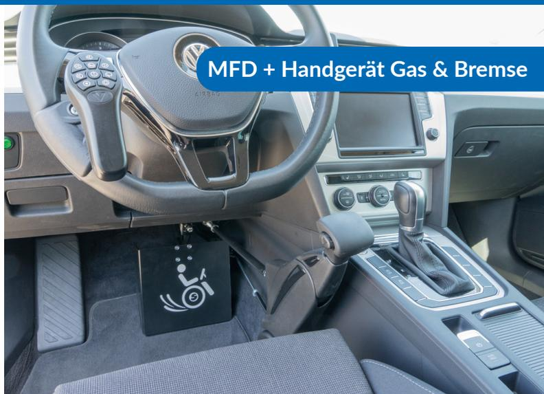
MFD + Handgerät Gas & Bremse
