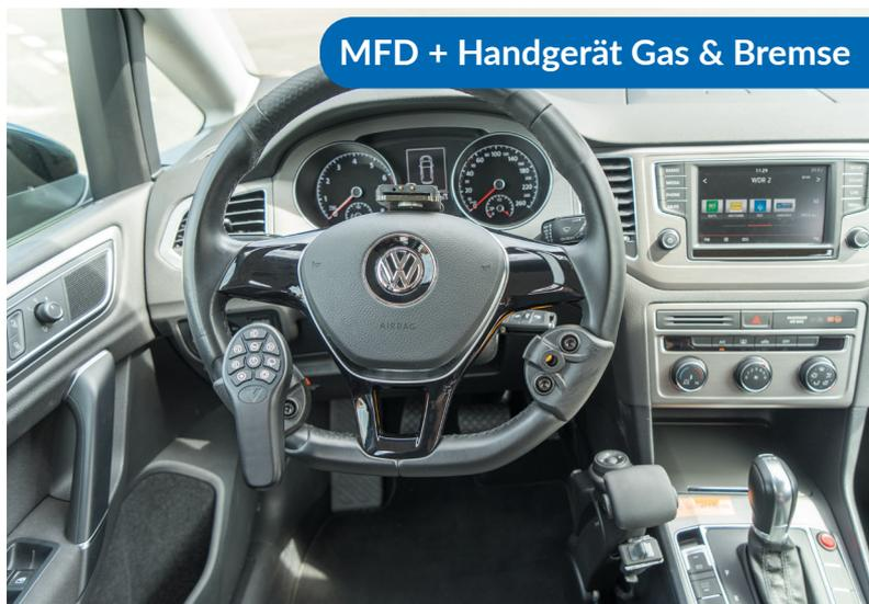
MFD + Handgerät Gas & Bremse
