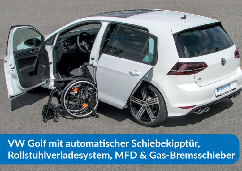
VW Golf mit automatischer Schiebekipptür, Rollstuhlverladesystem, MFD & Gas-Bremsschieber
