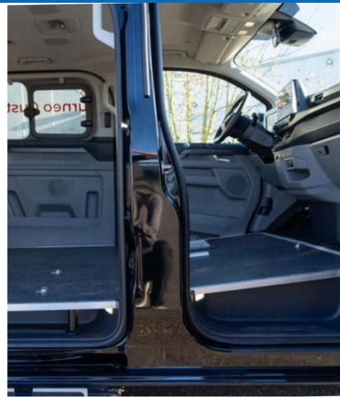
Der verbaute **Unterflur-Kassettenlift** (K70) ermöglicht einen mühelosen und barrierefreien Einstieg ins Fahrzeug.
