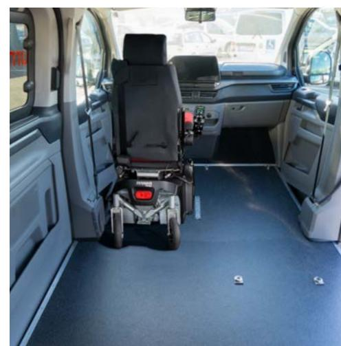
**Integrierter Rollstuhlplatz** hinter dem Fahrersitz mit Retraktoren zur sicheren Begurtung im Fahrzeuginnenraum.
